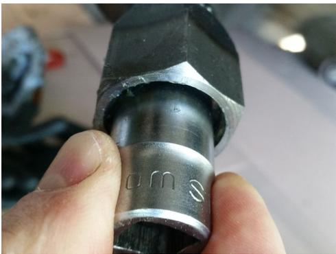
Tout nettoyer, couvrir la rotule de graisse, remplir la coupelle de graisse, graisser les rondelles et mettre tout ça en place.
